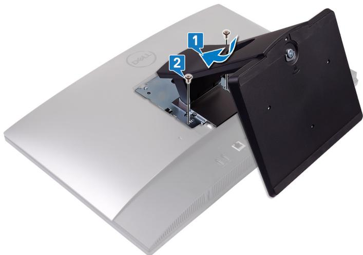
3 将支架护盖上的卡舌卡入后盖上的插槽中。
