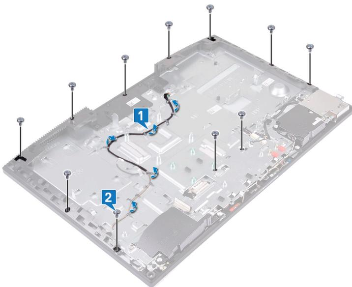
3 呈垂直位置放置计算机，按住显示屏面板和显示屏部件底座并小心地从中框和显示屏部件底座释放显示屏面板。
