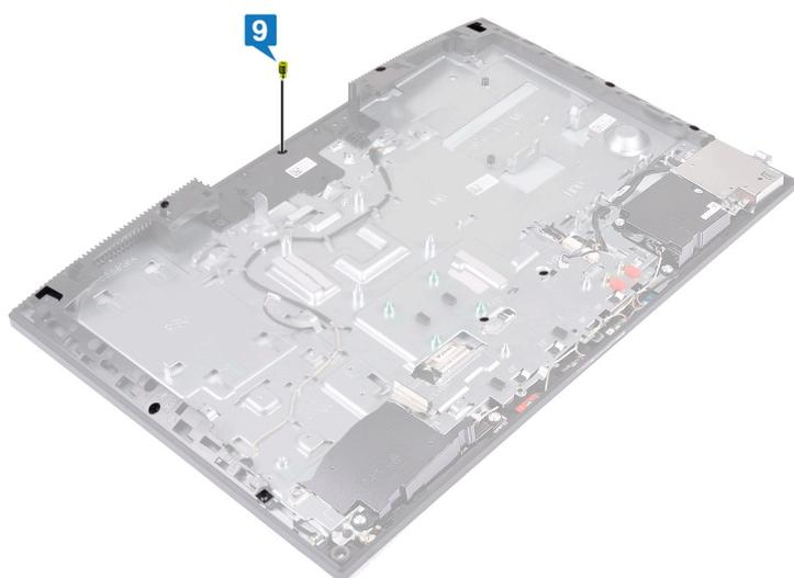
10 拧上将显示屏面板固定至中框和显示屏部件底座的螺钉 (M3x5)。
